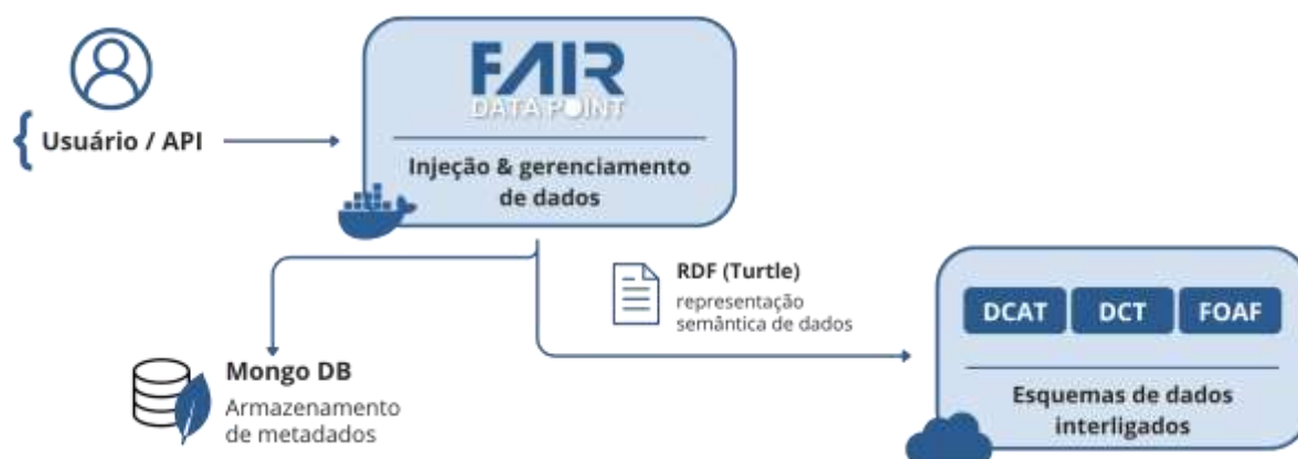
Figura 1: Arquitetura do FAIR Data Point. Fluxograma ilustrando a injeção de dados via FAIR Data Point (Docker) para MongoDB e a representação de metadados em RDF (Turtle) utilizando vocabulários FAIR (DCAT, DCT, FOAF).
